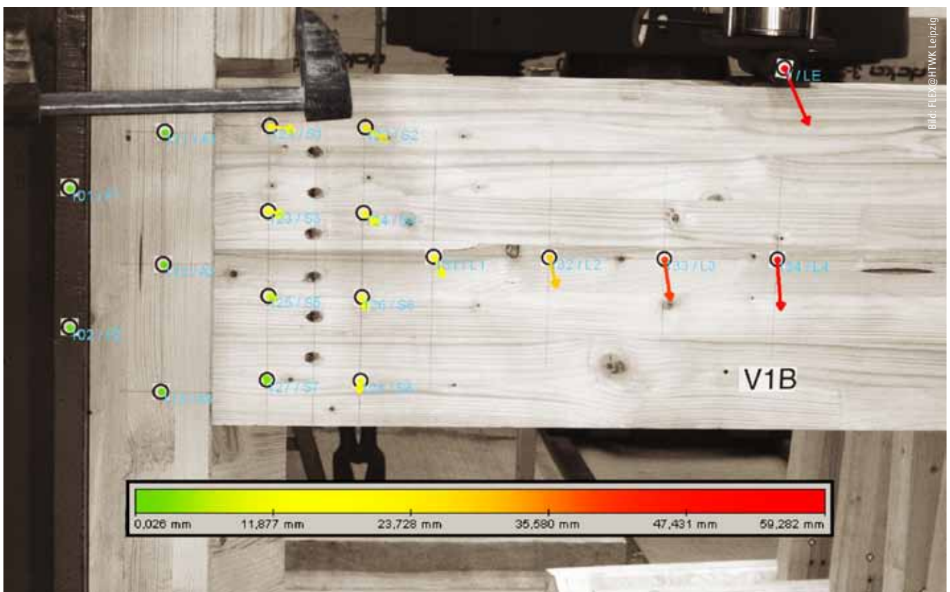
Abbildung 9: Die mittels Photogrammetrie gemessenen Verformungen zur Ermittlung der Verdrehung in der Verbindung.
