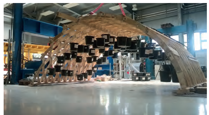
Bild 3. Belastungstests am ZoLinkR. Versuchsbogen mit sandgefüllten Eimern
